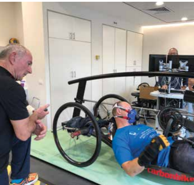
תמונה 7 א: רוכב אופני הידיים עמית חסדאי בזמן רכיבה על אופניו האישיים על גבי המסילה הארגומטרית Saturn® של חברת h/p cosmos ומאמנו מאיר כרמון. התמונה צולמה במעבדת מכון סילבן אדמס לספורט באוניברסיטת תל-אביב בעת בדיקה של ערכי צריכת חמצן
